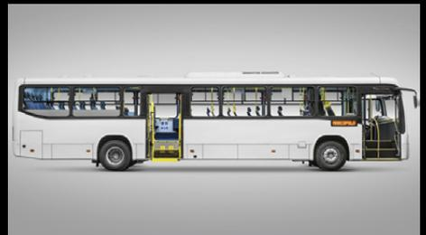
El diseño innovador de la carrocería cuenta con faldones modulares, formados por paneles móviles que permiten un excelente mantenimiento, acceso a los componentes del chasis y bajo costo en el mantenimiento.
