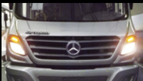
Mejor acceso frontal para mantenimiento; no es necesario desensamblar los faros principales para hacer cambio de filtro.
