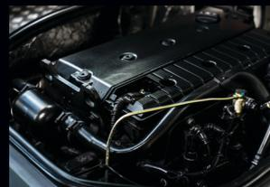
Motor Mercedes-Benz OM924 Euro V de 4 cilindros, con 154 hp, y un torque de 428 libras pie de 1200 a 1600 revoluciones por minuto.
